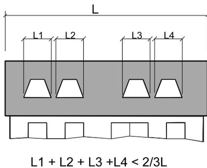
Bild 1: Schema Dachaufbauten
