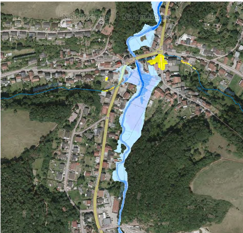
Abb. 41: Überflutungsgefahr am Odenbach bei Hochwasser HQ_{\text{extrem}} , Sturzflutgefahrenkarte [1] „Hochwassergefährdung“
