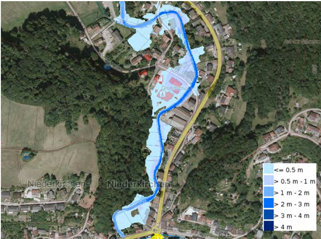
Abb. 52: Überflutungsgefährdung am Odenbach bei HQ_{\text{extrem}} , Sturzflutgefahrenkarte [1] „Hochwassergefährdung“
