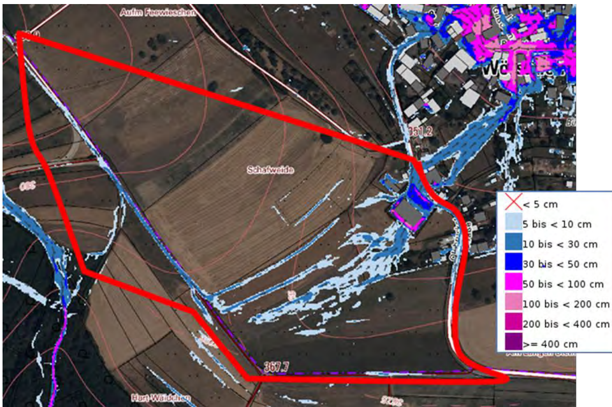
Abb. 75: Einzugsgebiet (rot) der Tiefenlinie Schafweide zur Olsbrücker Straße, Sturzflutgefahrenkarte [1] für SRI 7, 1 Std.
