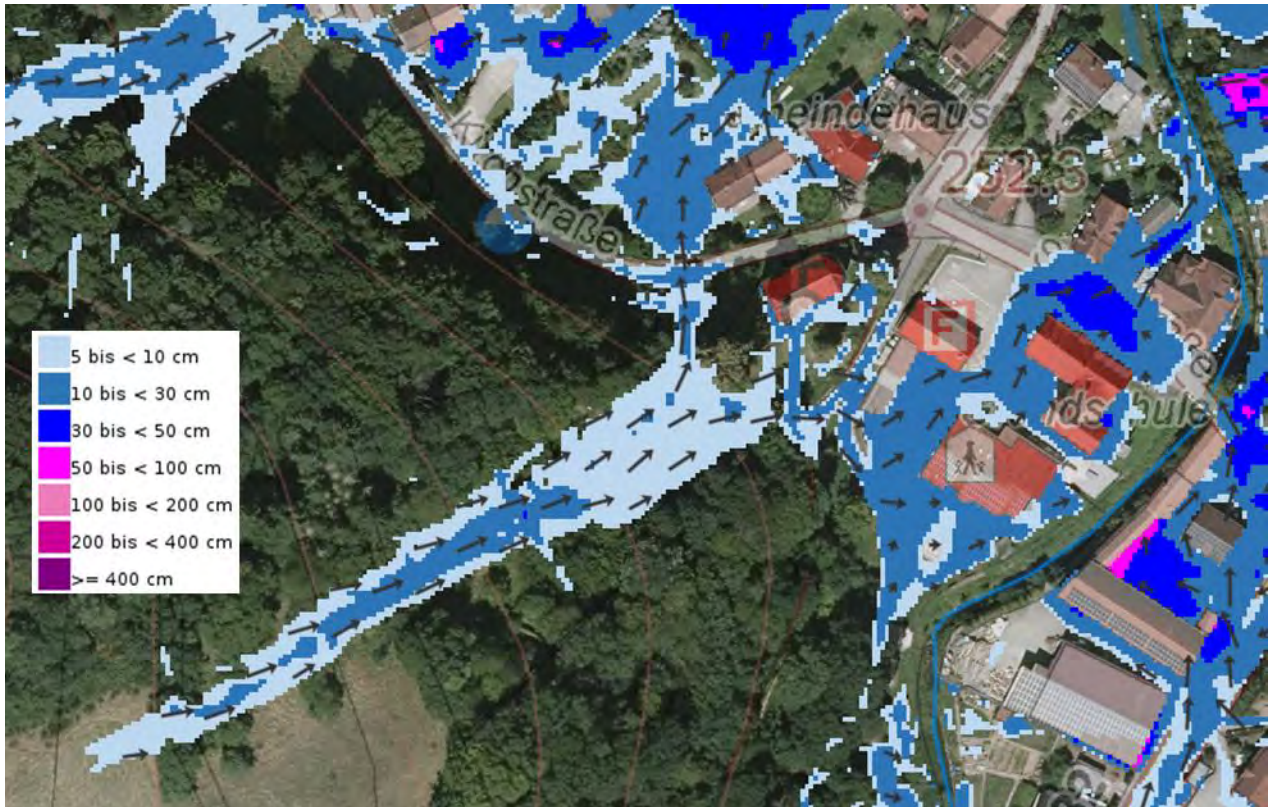
Abb. 63: Überflutungsgefährdung des Bereichs Grundschule bei außergewöhnlichen Starkregen, Sturzflutgefahrenkarte [1], für SRI 7, 1 Std. [1]
