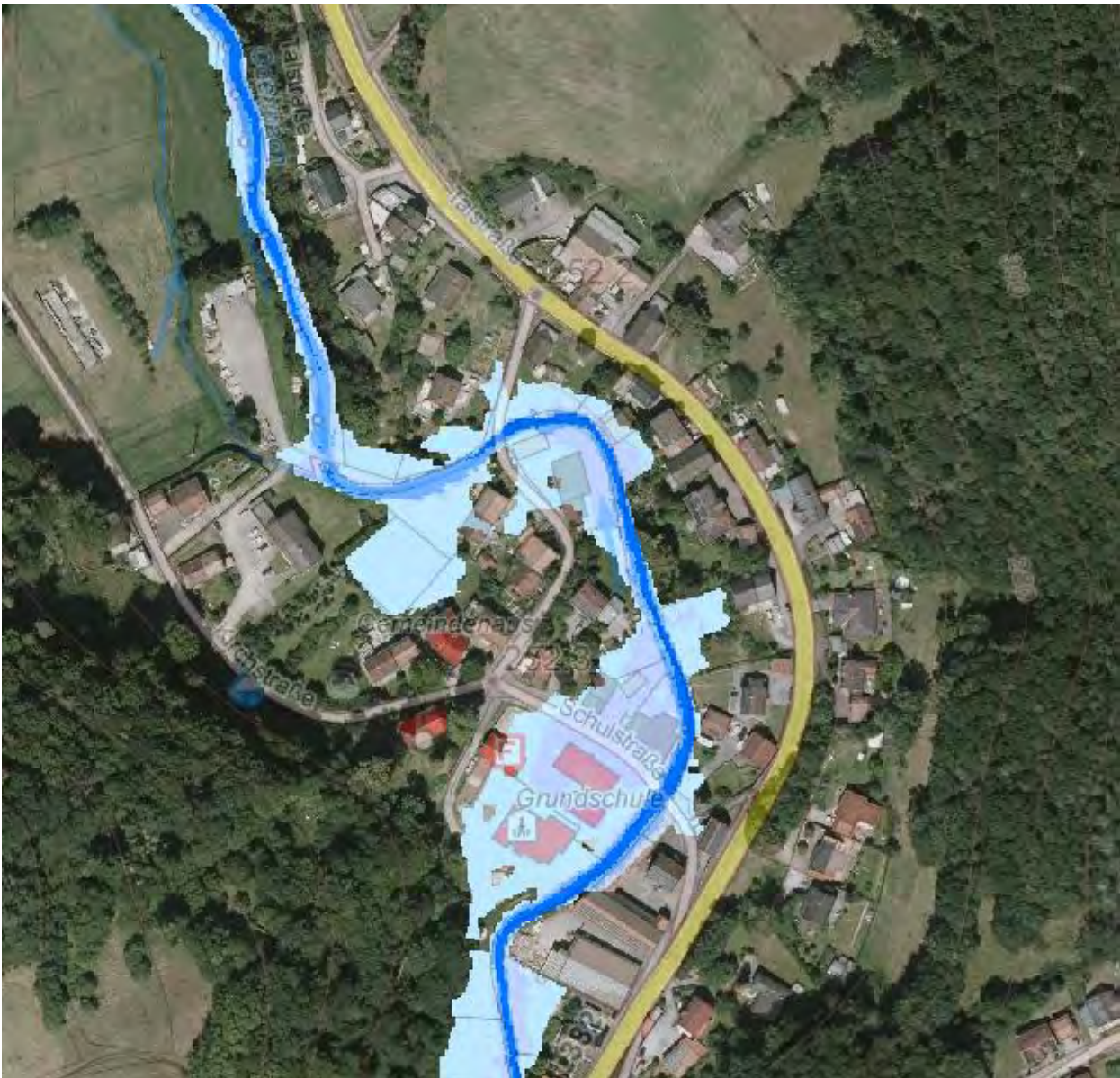
Abb. 59: Überflutungsgefährdung am Odenbach im Norden von Niederkirchen bei HQ_{\text{extrem}} , Sturzflutgefahrenkarte [1] „Hochwassergefährdung“
