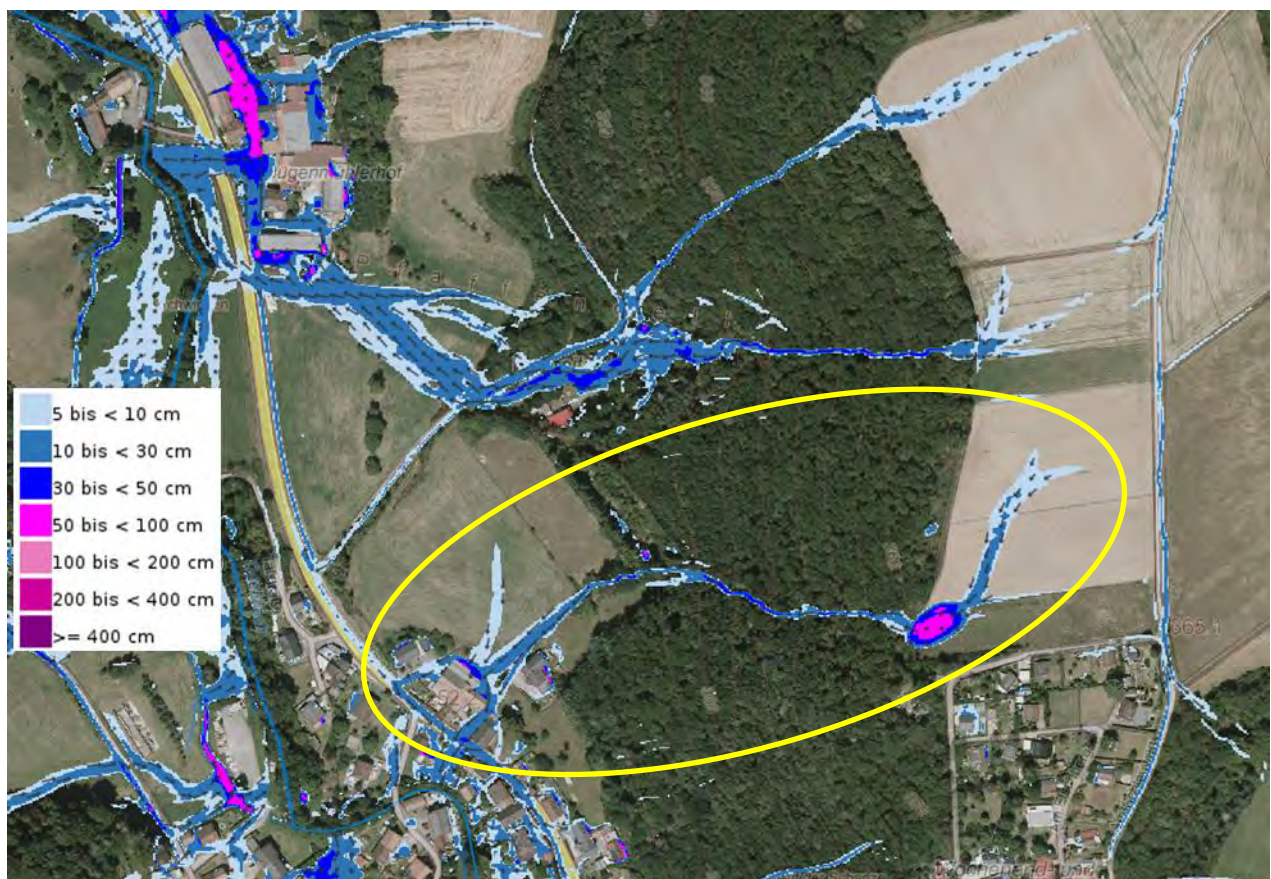
Abb. 64: Überflutungsgefährdung der nördlichen Talstraße, bei außergewöhnlichen Starkregen, Sturzflutgefahrenkarte [1] für SRI 7, 1 Std.
