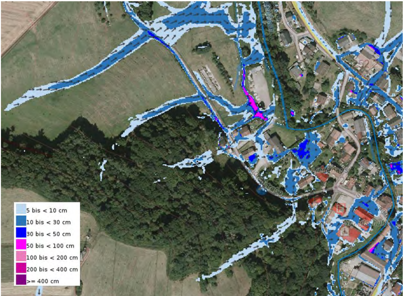
Abb. 61: Überflutungsgefährdung im Bereich Kirchstraße-Schulstraße bei außergewöhnlichen Starkregen, Sturzflutgefahrenkarte [1], SRI 7, 1 Std.
