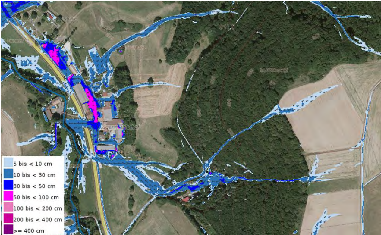
Abb. 65: Überflutungsgefährdung des Bügenmühlerhofs bei außergewöhnlichen Starkregen, Sturzflutgefahrenkarte [1] für SRI 7, 1 Std.
