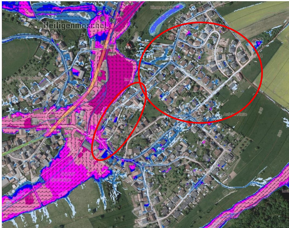
Abb. 51: Abflusswege für Oberflächenwasser im Bereich Kirchgasse, Sturzflutgefahrenkarte des Landes von 11/2023 für SRI 10, 1 Std. [1]
