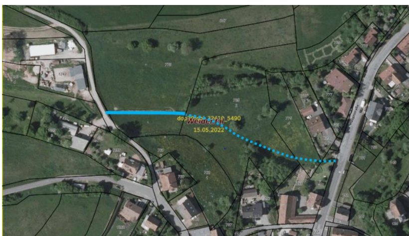
Abb. 50: Vorgeschlagene Trasse zur Rückverlegung des Flutgrabens
