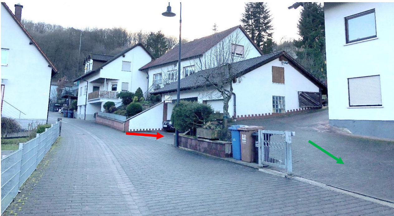
Abb. 18: Überflutungsfördernde (rot) und überflutungsresiliente Bauweise (grün)
