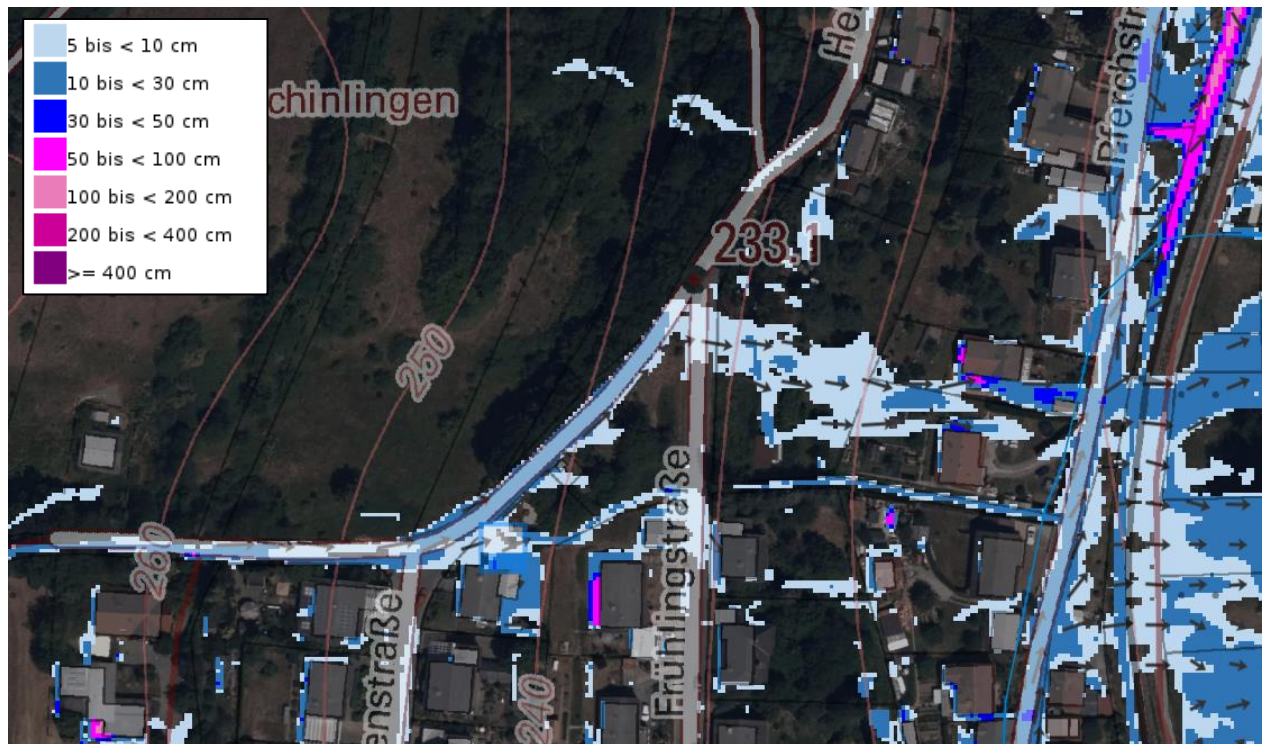
Abb. 107: Überflutungsgefährdung in Sonnenstraße, Frühlingsstraße und Pferchstraße, Sturzflutgefahrenkarte für SRI 7, 1 Std. [1]
