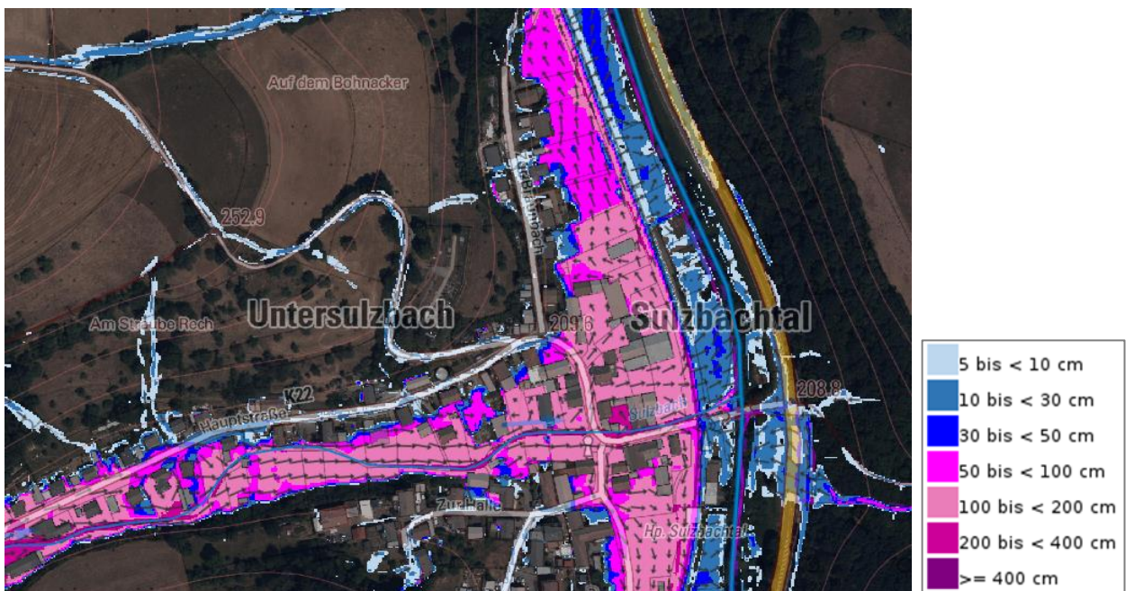
Abb. 41: Überflutungsgefahr in der Hauptstraße bei Starkregen, Sturzflutgefahrenkarte für SRI 7, 1 Std. [1]
