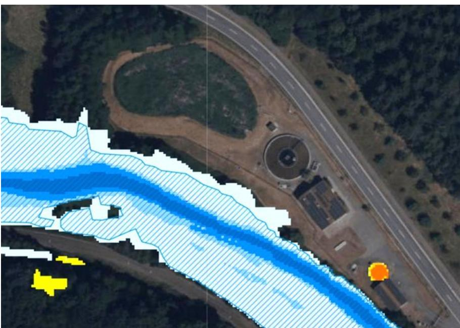
Abb. 8: Hochwassergefahrenkarte im Bereich der Kläranlage Olsbrücken für  $HQ_{100}$  (schraffiert) und  $HQ_{\text{extrem}}$  (hellblau) [1]
