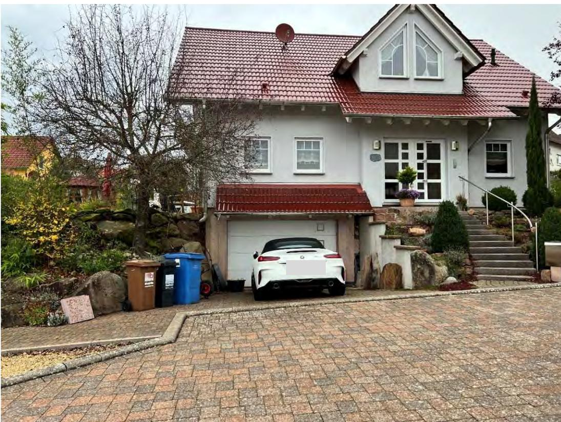
Abb. 18: *Beispiel für stark überflutungsgefährdete Garage*
