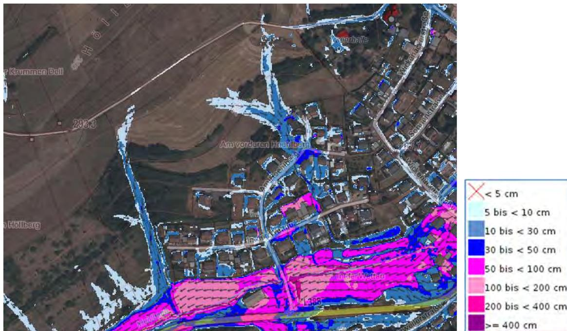
Abb. 100: Abflusswege im Neubaugebiet „Hoehlberg“, Sturzfluggefahrenkarte des Landes [1] für extremen Starkregen, SRI 10, 4 Std.
