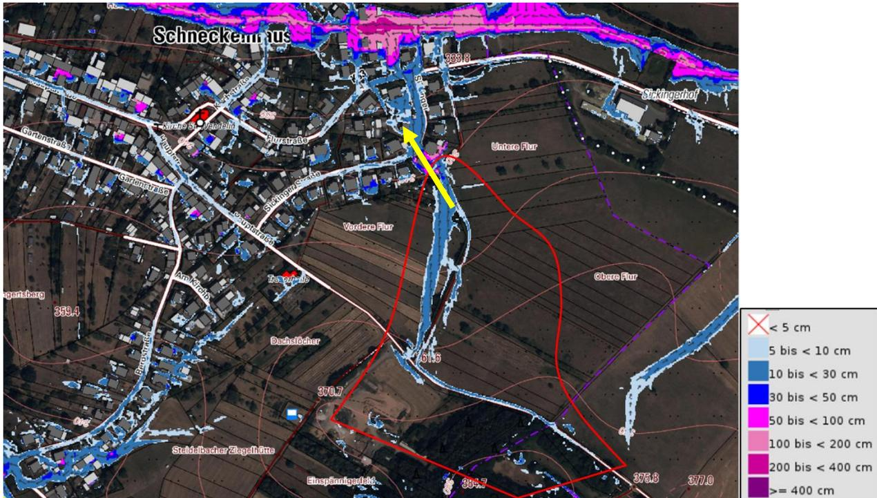
Abb. 53: Einzugsgebiet (rot) der Tiefenlinie, Sturzflutgefahrenkarte des Landes von 11/2023 für außergewöhnlichen Starkregen, SRI 7, 1 Std.
