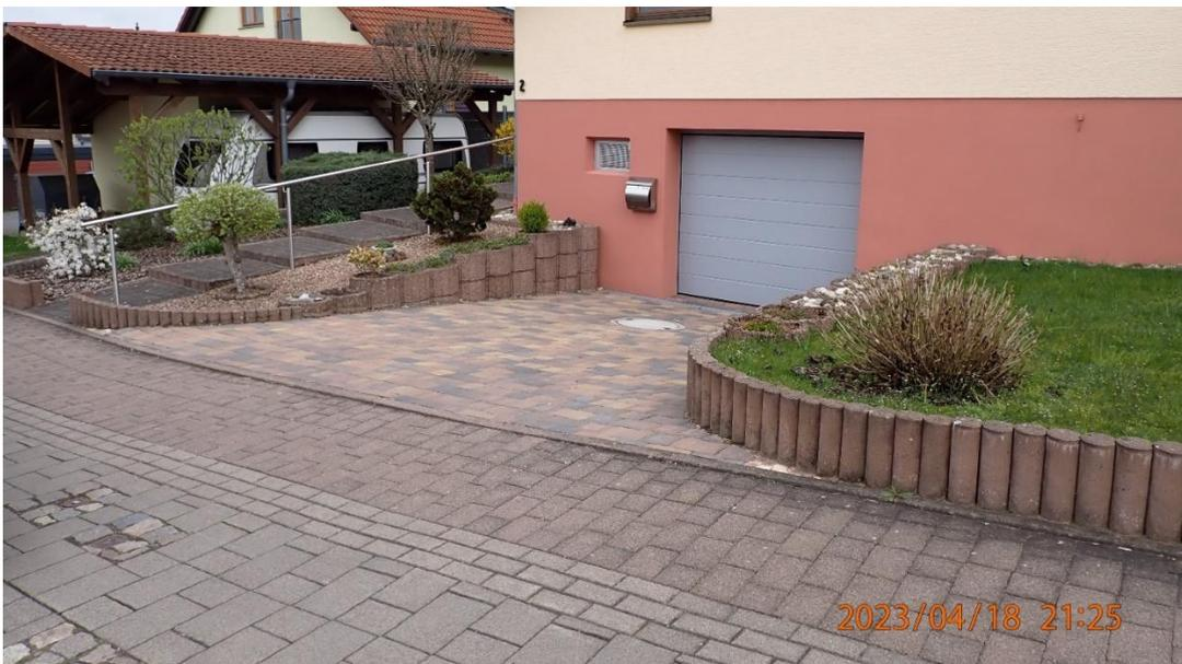
Abb. 12: Beispiel für potenziell überflutungsgefährdete Garage
