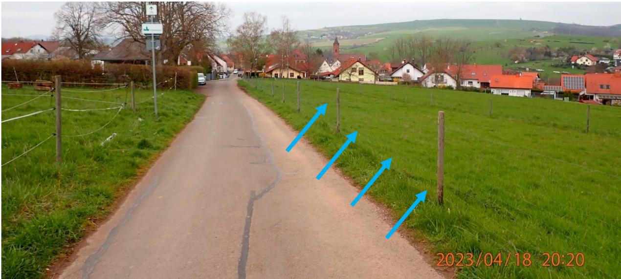
Abb. 69: Geeigneter Bereich zur breitflächigen Querentwässerung des Weges in die angrenzende Fläche
